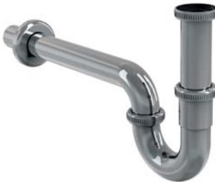
A4320 Сифон для умывальника DN32, U-форма с накладной гайкой 5/4", металл
