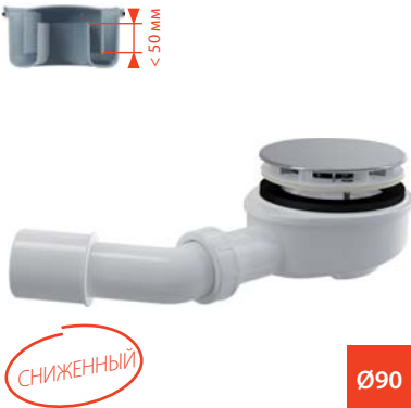
A492CR Сниженный сифон для толстостенного душевого поддона, хром
